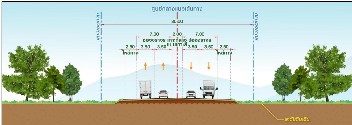
รูปที่ 7 รูปแบบทางหลวงขนาด 4 ช่องจราจร แบ่งทิศทางการจราจรแบบเกาะสี่
